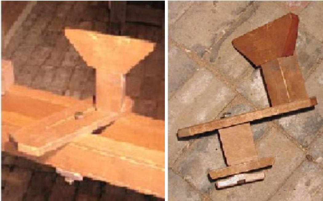
FIGURE 2.14.: Appui-outil en gros plan
