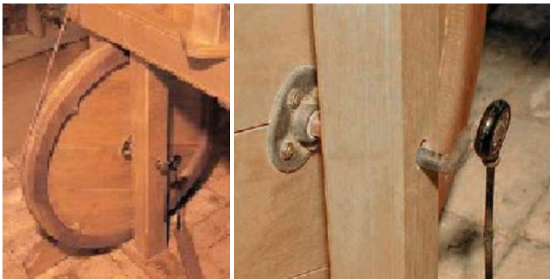
FIGURE 2.15.: volant d'inertie avec moyeu en gros plan
