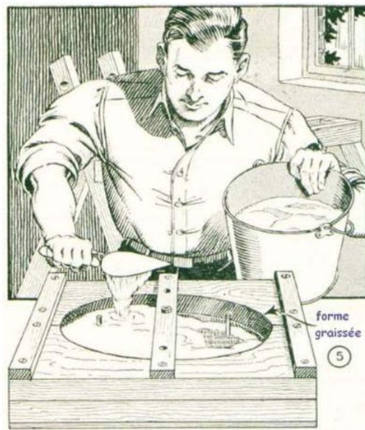
FIGURE 3.6.: moulage du volant
